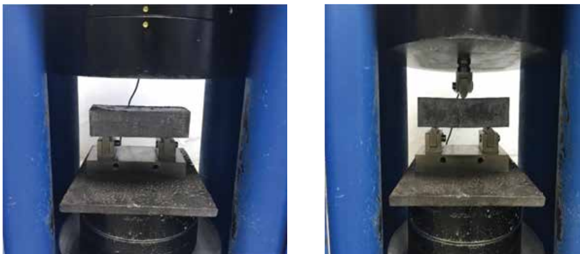
Figura 4. Përcaktimi i rezistencës në tërheqje nga përkulja e trarëve të betonit transparent
