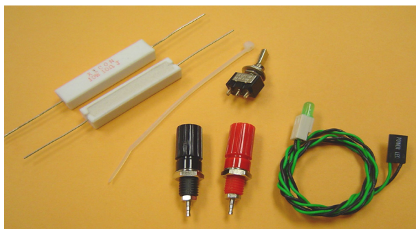
Fig.Nr.4 Elementë elektronike për ndërtimin burimit të tensioneve laboratorike.
