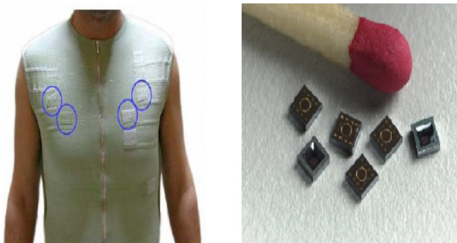
Figura 2.1: (Majtas) Sensor të futur në në bluzë. (Djathtas) Madhësia e përshpejtuar MEMS, krahasuar kjo me majën e një shkrepseje.
